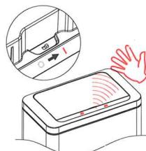
**センサー休止オプション:**フタの裏側にセンサースイッチがあります。このスイッチでセンサー機能を休止させることができます。スイッチがオン（|）の時はセンサーモードです。この時ごみ箱はセンサーでも指でタッチパネルを押しても作動します。スイッチがオフ（○）の時はマニュアルモードとなりセンサー機能は休止し、指でタッチパネルを押した場合のみ開閉します。センサー モードとマニュアルモードについては以下の通りです。
