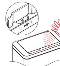
**センサー休止オプション:** フタの裏側にセンサースイッチがあります。このスイッチでセンサー機能を休止させることができます。スイッチがオン( | )の時はセンサーモードです。この時ごみ箱はセンサーでも指でタッチパネルを押しても作動します。スイッチがオフ(○)の時はマニュアルモードとなりセンサー機能は休止し、指でタッチパネルを押した場合のみ開閉します。センサーモードとマニュアルモードについては以下の通りです。
