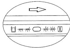
3 ) センサーが手または物体を検知するとLEDが左から右へと点灯します。
