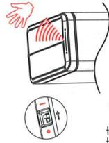
センサー感知範囲：ボタンパネル上方(約20cm)に手をかざすと感知してふたが開きます。
